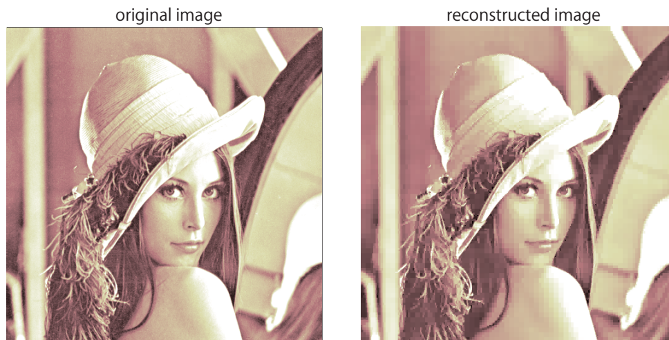
図 7: 原画像と絶対値の小さいものから 95% のウェーブレット係数を 0 にしたものからの再構成結果の比較。
